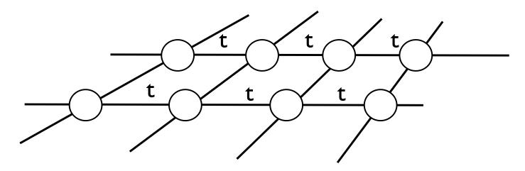
$$-t\sum_{rr'}(c_{\sigma r}^{\dagger}c_{\sigma r}+CC)$$
